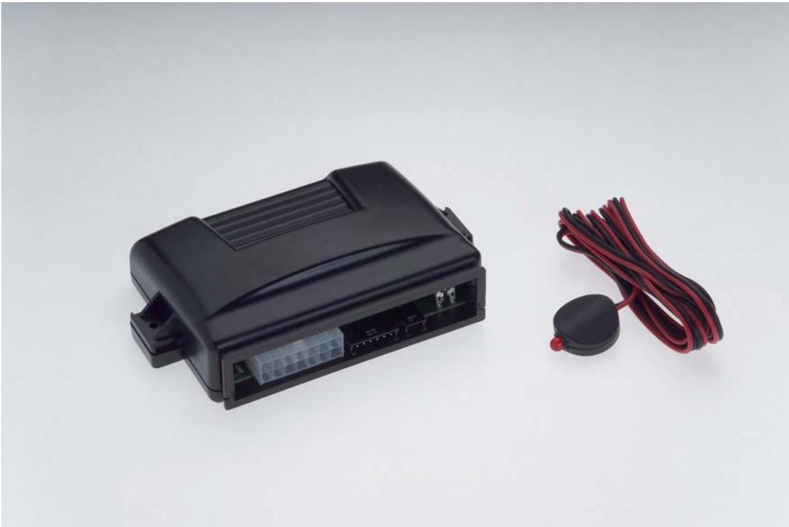
Centrale di allarme modulare applicabile ad autoveicoli con sistema CAN BUS.
